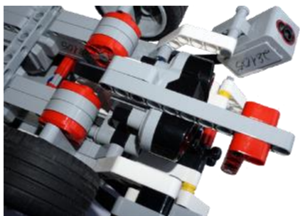
Figura 4 – Montagem do suporte extra (vista de baixo).
