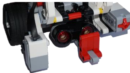
Figura 5 – Montagem do suporte extra (vista de frente).
