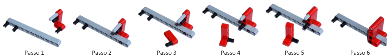
Figura 3 – Instruções para construir o suporte extra.
