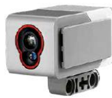
Figura 5 – Sensor de cor.
