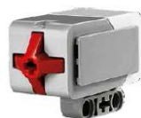
Figura 4 – Sensor de toque.
