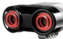
Figura 6 – Sensor de ultrassons.
