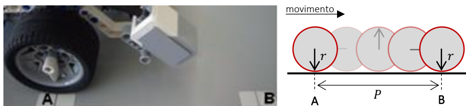
Figura 1 - Esquema ilustrativo da relação entre o perímetro das rodas do robô e uma rotação.
